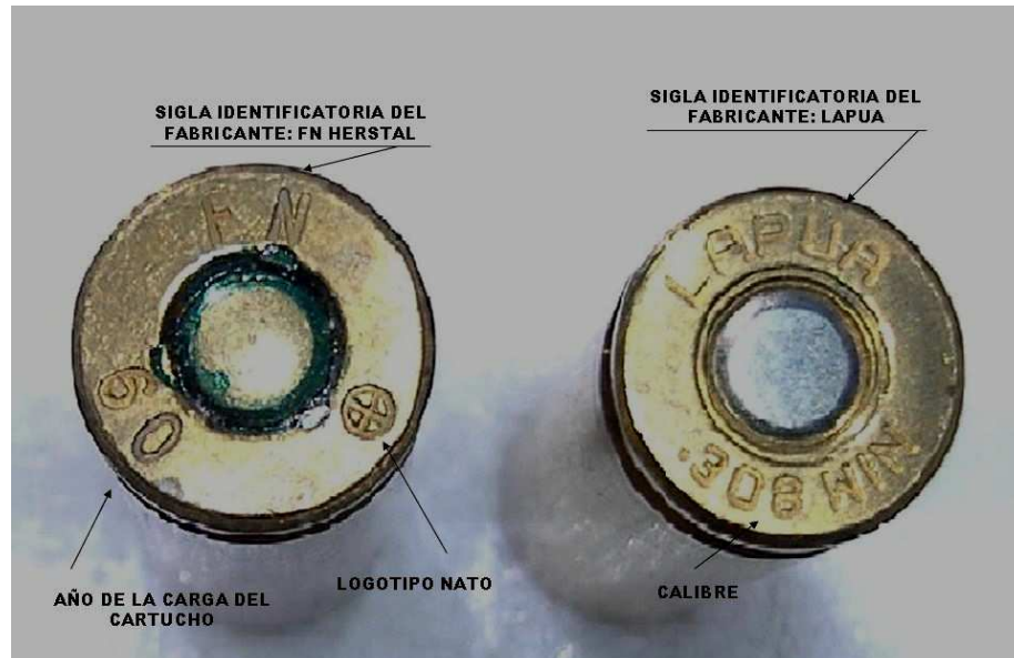
En la imagen, sobre la izquierda, una vaina militar con la simbología NATO. La restante, de tipo comercial, de origen Finlandés. Las dos del calibre 7,62 x 51 mm.
